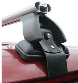
Установите багажник на край крыши и закрепите металлическую скобу за дверной проем
